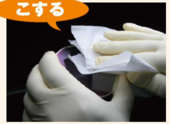
ティッシュペーパーでレンズの両面を10回ずつ擦ります。(静電気を起こすため)
